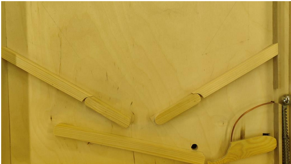
Die Schläger, der Servoarm und die Startbahn fertig gebaut
