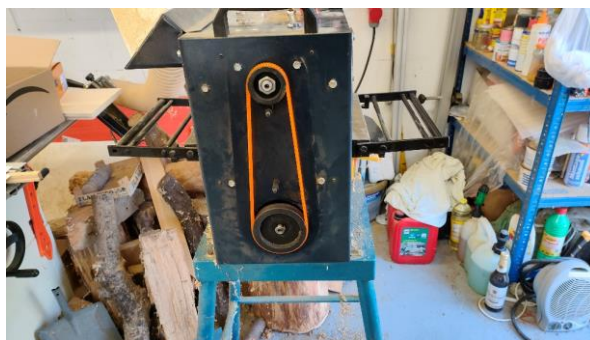
Der neue Riemen in der Hobelmaschine
