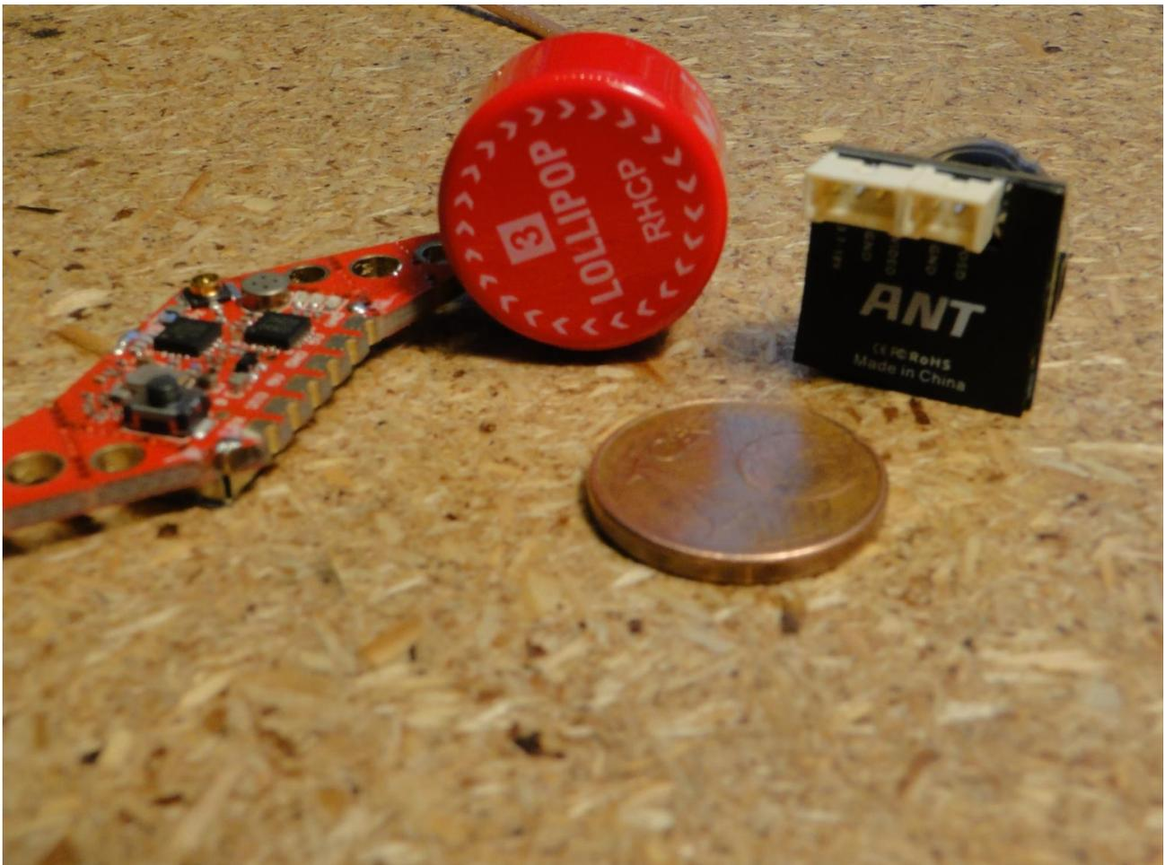
Als erstes habe ich den VTX mit dem FC verkabelt, danach die Kamera mit dem VTX und dem FC. Der VTX benötigt folgende Anschlüsse: 5V, GND (Ground, also Minus), VID, also Video in und RX bzw. am FC dann natürlich TX. RX steht dabei für Receiver, also Empfänger und TX für Transmitter, also Sender. Diese gehören zu den sog. UART's. Ein UART ist wie ein USB-Anschluss am PC, man kann über diesen also „Geräte“ an den FC anschließen, bzw. es „Geräten“ ermöglichen, mit
