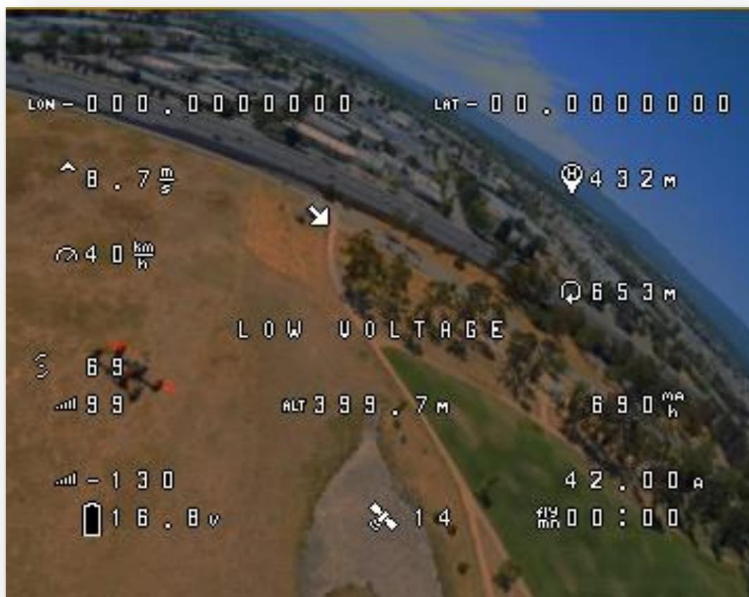
Dazu zählen z.B. Akku-Spannung, aktueller Stromverbrauch in Ampere, der bisher verbrauchte Strom in MAh, die Flugzeit, die Höhe und die Steigrate in Metern, die zurückgelegte Strecke pro Flug sowie die Entfernung zum Home Point, die Daten zur Empfangsstärke und die GPS-Koordinaten und einige weitere Daten.
