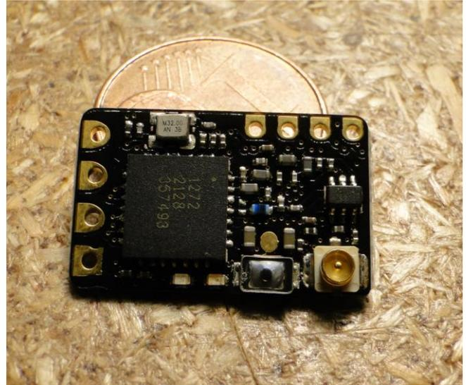
Zuerst habe ich den Nano an den beim FC mitgelieferten Stecker mit Hilfe des Anschlussplans, auf dem die Bezeichnungen der Löt-Pads dargestellt waren, angelötet und anschließend die Antenne aufgesteckt. Als letztes habe ich das Ganze noch mit Schrumpfschlauch vor Staub und Co. geschützt und den Stecker an den FC angeschlossen.
